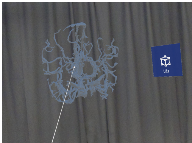
Figur 7. Användarens vy då en låsknapp har lagts till. På knappen står texten "Lås" vilket visar att modellens position kan fixeras i 3D-rummet. Strecket och punkten visar att användaren interagerar med 3D-modellen.
