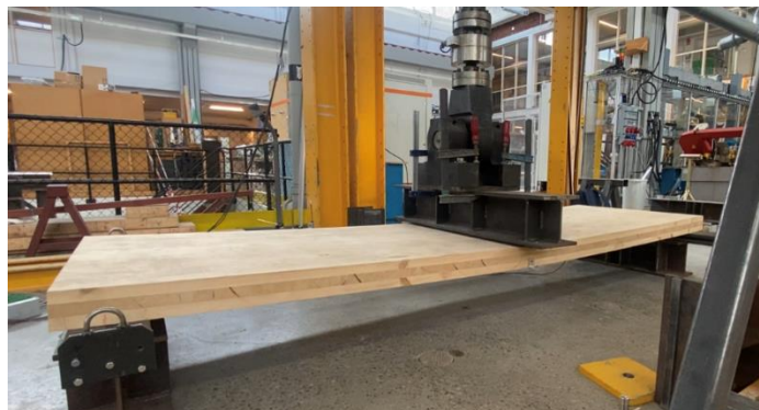
Figur 1: En figur på en av testsituationerna, där ett litet golv av KL trä är belastad med hjälp av en maskin.
