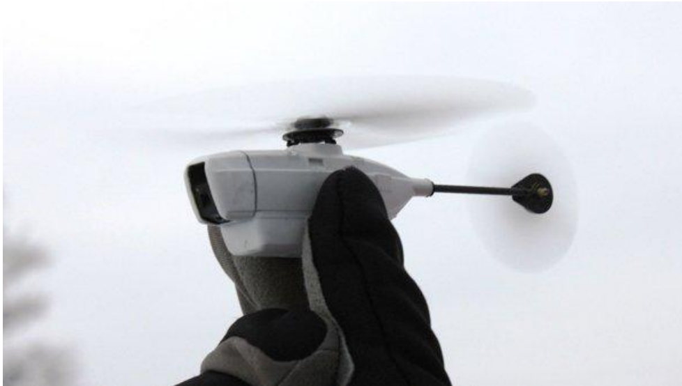
Black Hornet nano, utvecklad 2014 av norska Prox Dynamics för övervakning och rekognisering. Vikt 17 gram, flygtid 20min, räckvidd 1.6km. Pris ca 0.7Mkr
