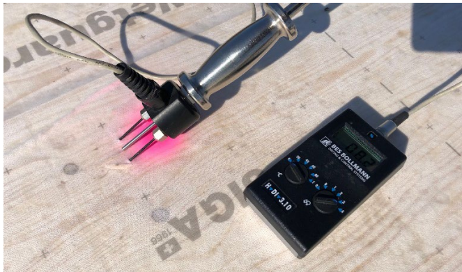
Figur 36 - Mätning av yfuktkvot med resistansfuktkvotsmätare.
