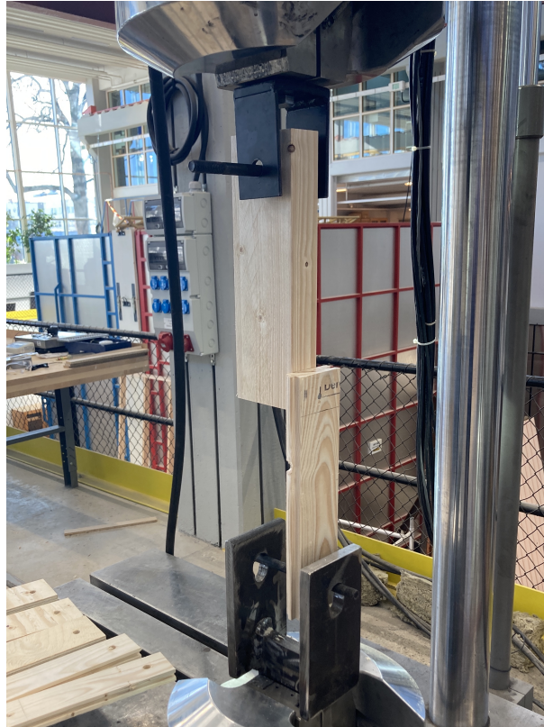
Figur 3.10: Bild över hur test på spikförbandet utfördes.
