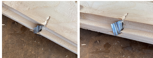
Figur 3.15: Bilden visar den vanligaste deformationen hos stiftet när det utsätts för last, vilket tyder på att det pågår en typ av böjning och inte ren skjuvning.
