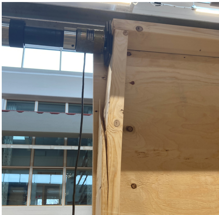
Figur 3.29: Brott i regel vid test av 1200mm plywoodskiva.
