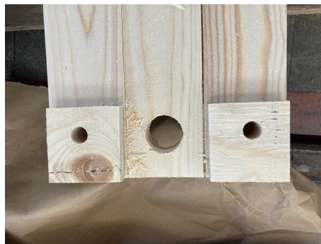
Figur 3.4: Bild på nedre delen av provkroppen med plywoodförstärkning och det större hålet som tillåter dymlingen att löpa genom utan att påverka mittenbrädan.
