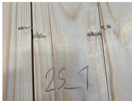
Figur 3.16: Bilden visar ett typiskt beteende hos stiften när de har deformerats.
