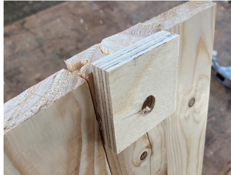
Figur 3.20: Bilden visar ett hålkantsbrott som kan ske då antalet stift är många.
