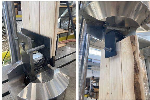
Figur 3.6: Bilder på undre och övre infästningen till provriggen.
