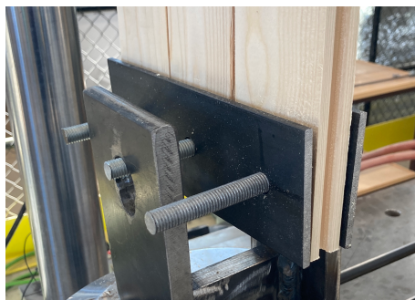
Figur 3.3: Bild på det nedre gaffelfästet. I mittenbrädan är ett stort hål borrarat så att mittersta dymlingen inte är i kontakt med brädan.
