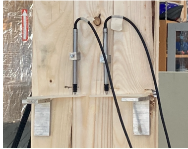
Figur 3.5: Bild på LVDT-mätarna monterade på provkroppen.
