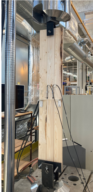
Figur 3.2: Bild på provriggen med en provkropp. Mitt på provkroppen är de två LVDT givarna fästa.
