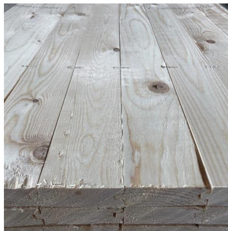
Figur 1: Råspontsluckor, där de enskilda spontade brädorna är ihopsatta med metallstift.
