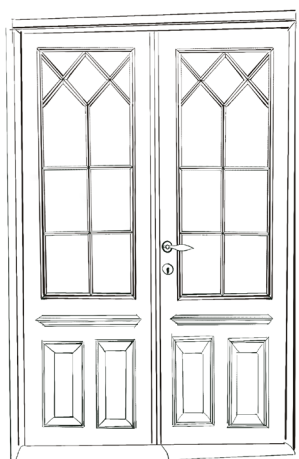
Spegeldörr med sprö- jsade fönster
