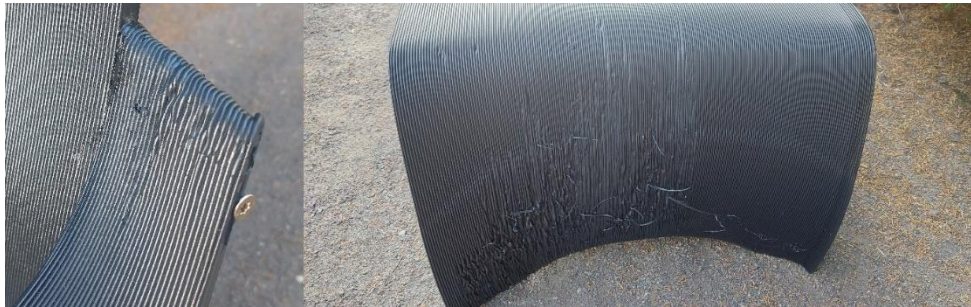
Figur 48: Delar av fullstora utskriften med misslyckad utskrift. Till vänster övre delen av armstödet samt till höger ena sidan av soffbordet
