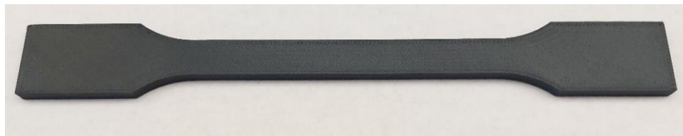
Figur 8: Provstav för tester av materialegenskaper vid dragprov
