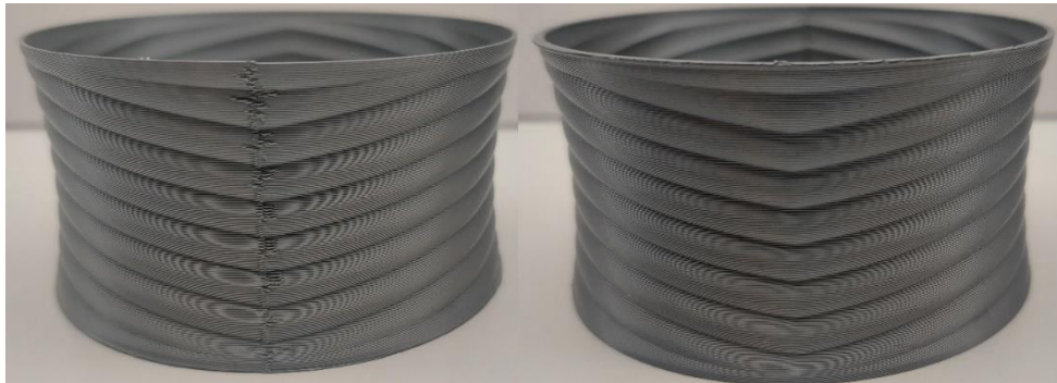
Figur 2: Jämförelsebild mellan lager för lager utskrivning till vänster med sömmen som skapas på varje startpunkt för lagret och vase mode utskrivning till höger som saknar sömmen, bild tagen av författaren
