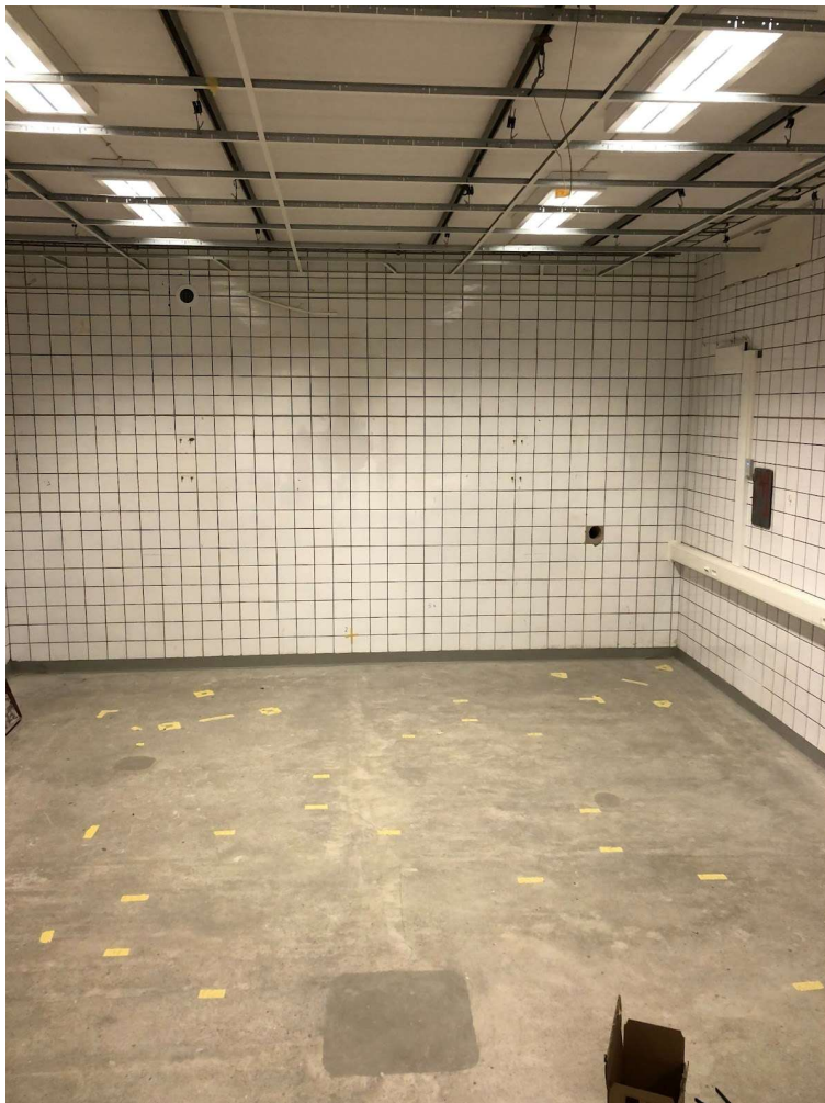
Figur 2.2 Efterklangsrums i akustiklaboratoriet på LTH, Lund.
