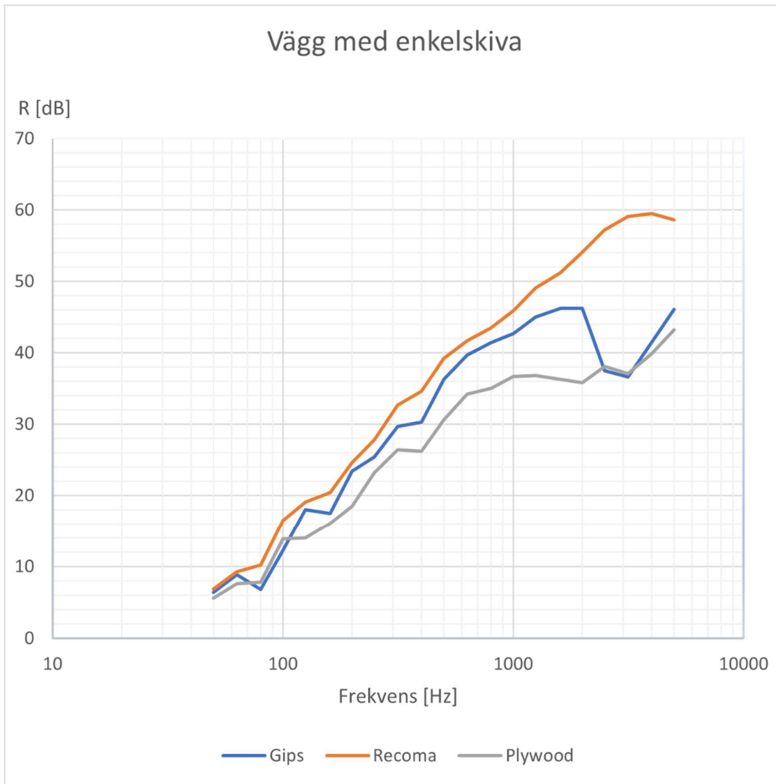
Figur 5.1 Jämförelse av reduktionstal vid olika frekvenser för samtliga enlayersväggar.
