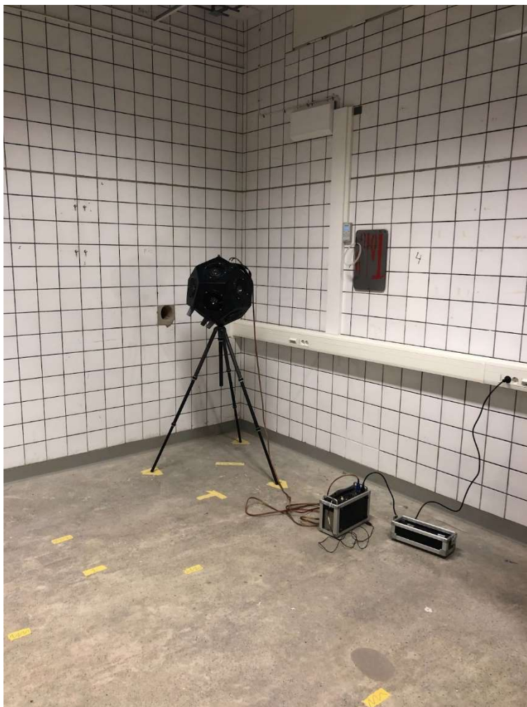
Figur 3.5 Högtalare och förstärkare som har tilldelats en placering i sändarrummet utifrån de krav som ställs i ISO 10140–4:2021.
