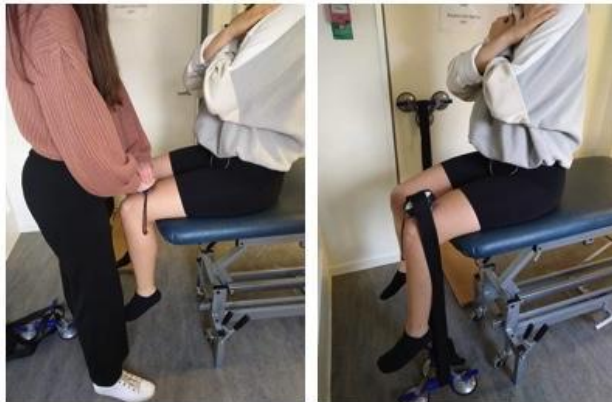
Figur 3. Mätning av isometrisk styrka i höftflexion med handhållen dynamometer och förankrad dynamometer
