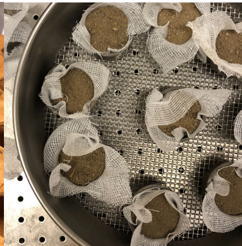
Figur 4: Jordprover i cylinderrör nedsänkta i vatten.
