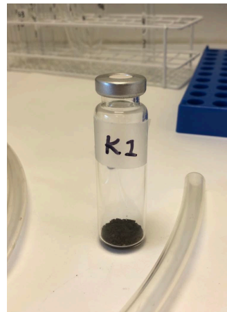
Figur 11: Provrör med jord inför respirationsmätning.
