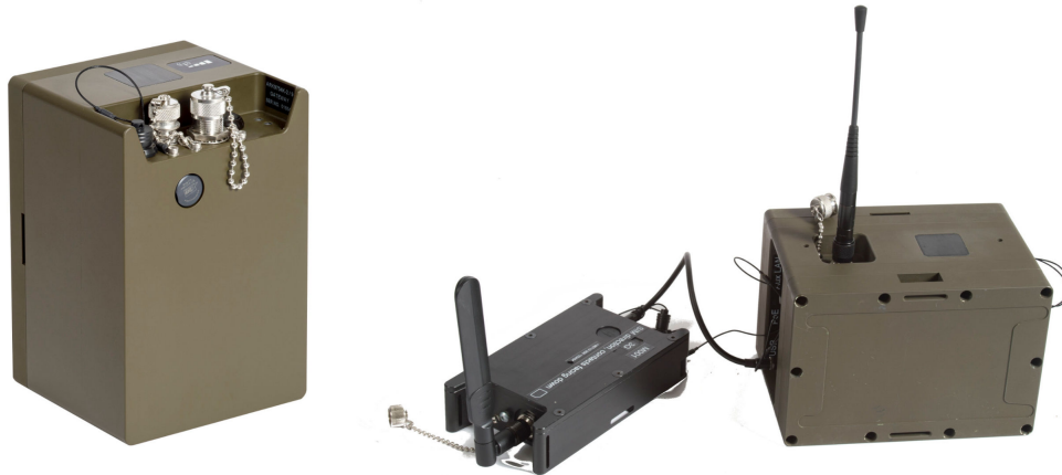
Figur 4.4: Vänster: Basenhet(Gateway). Har anslutning för antenner till två olika radiotyper. Höger: Video Gateway. Enhet som hanterar videostömmar. På bilden är det svarta modemmet anslutet.
