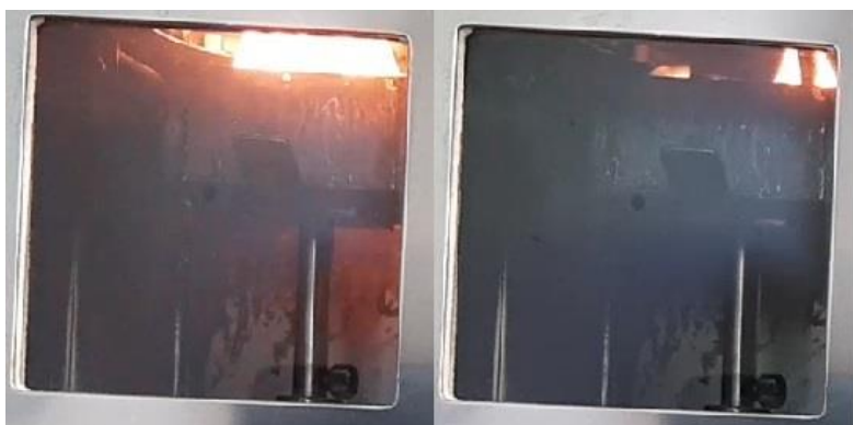
Figur 14: Skillnad i var i provhållaren det brinner, tidigt skede vänster mot sent skede höger, polyeten 17 % syre försök 1.
