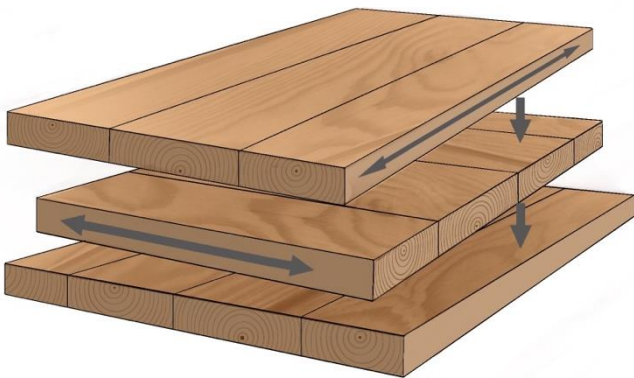
Figur 7. Schematisk bild som visar uppbyggnaden av KL-trä.
