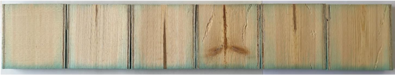
Figur 25. Bild på prover för kapilläruppsugningsförsöket. De tre första proverna från vänster är från IsoTimber och resterande tre är av massivt trä.
