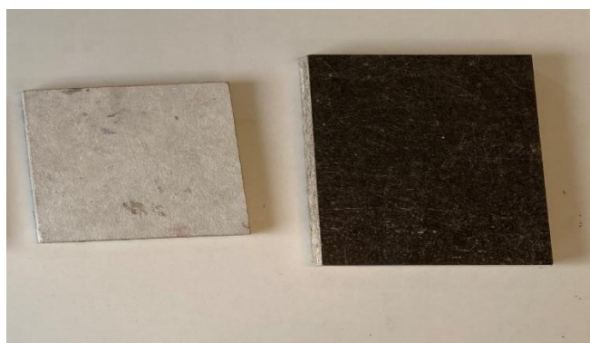
Figur 9, visar den glasfiberbäddad skivan till vänster och den fanerbäddad skivan till höger.
