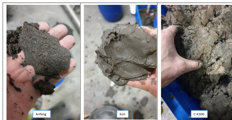
Figur 7.3: Anrikningssand innan laborationsundersökning (foto från Tailings Consultants Scandinavia AB)
