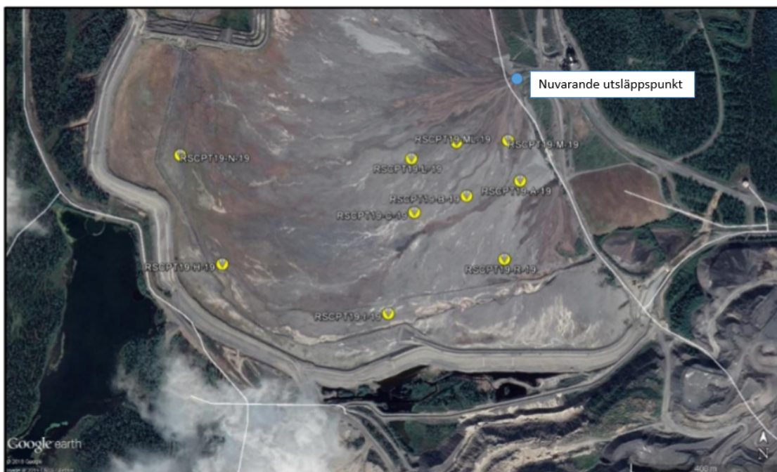
Figur 7.1: Placering av mätpunkter för CPT i Svappavaara gruvdamm (ConeTec Investigations Ltd., 2019)
