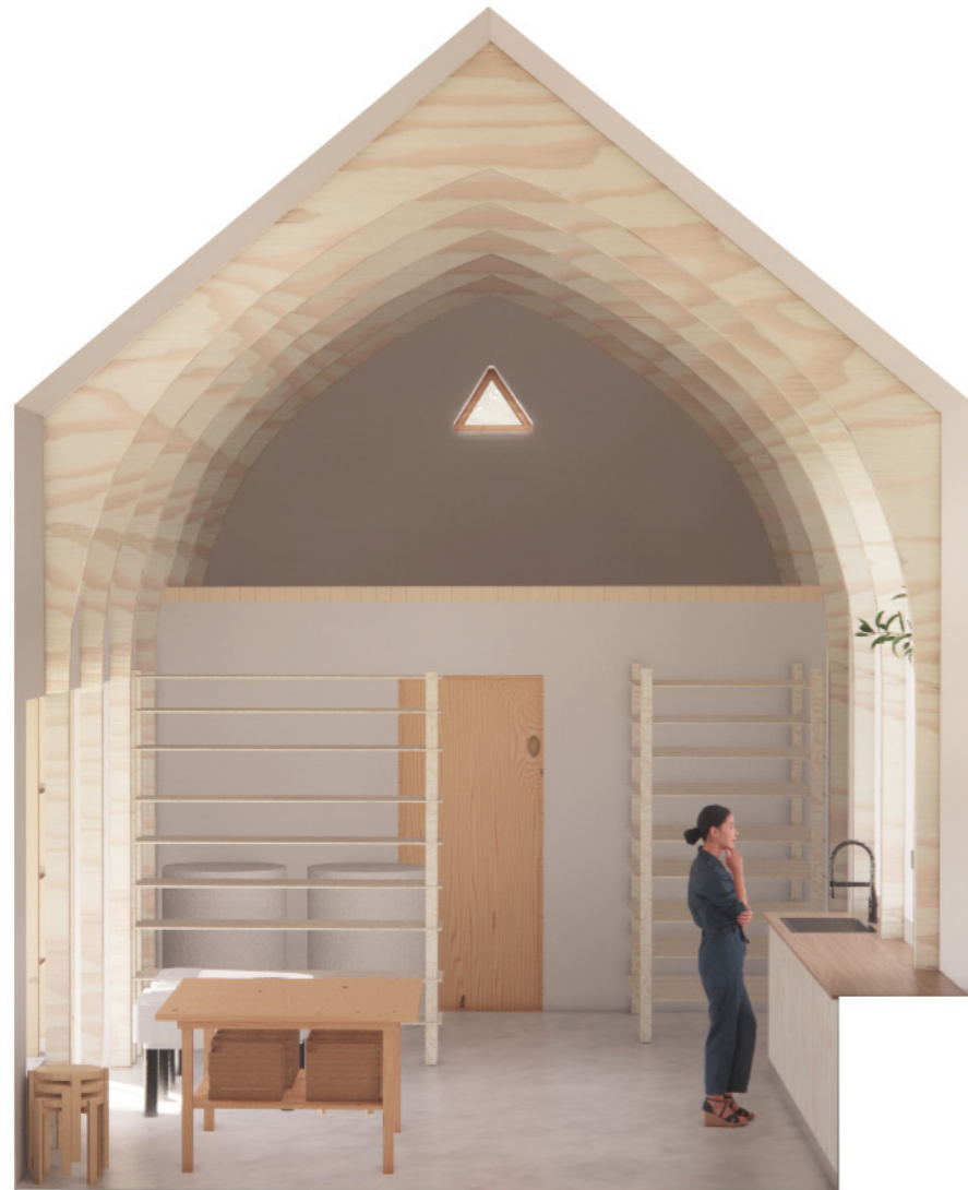
Ateljén. Här går taket upp tillnock. Väggarna är vitputsade
