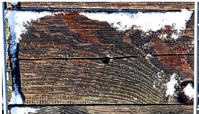
Figur 4.9: Spricka i en provbit
