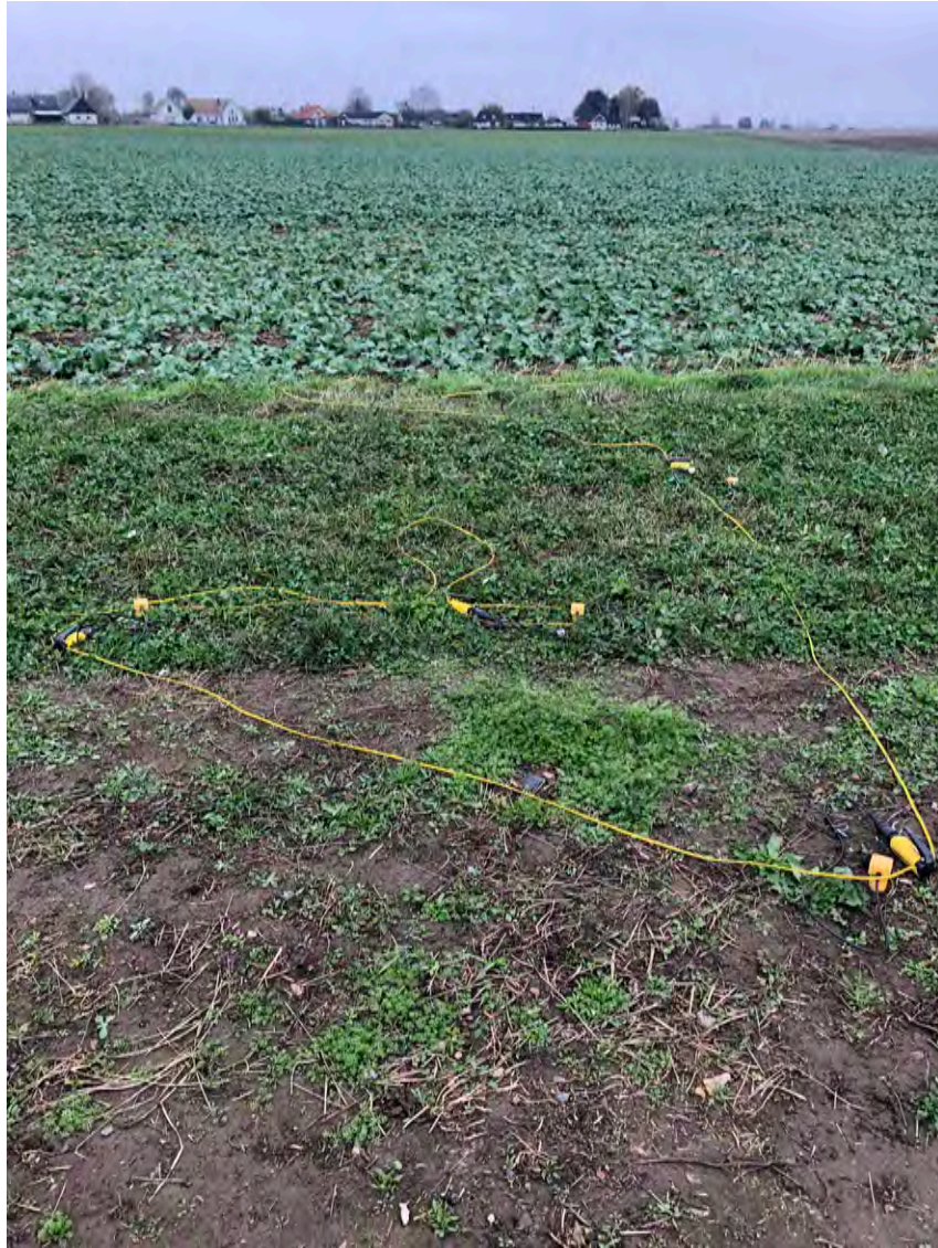
Figur 30 De innersta triangelarna i fält, med geofoner kopplade till kabeln med klämmor. Kabeln drogs i en viss ordning för att på ett så effektivt sätt som möjligt nå alla geofoner.
