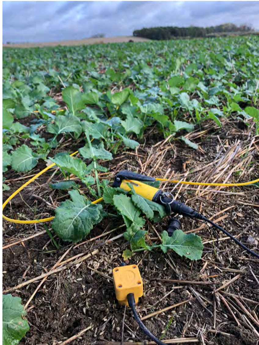
Figur 29 Geofon (här i gult), kopplad till kabeln med hjälp av en klämma, i vegetationen i Grevie.
