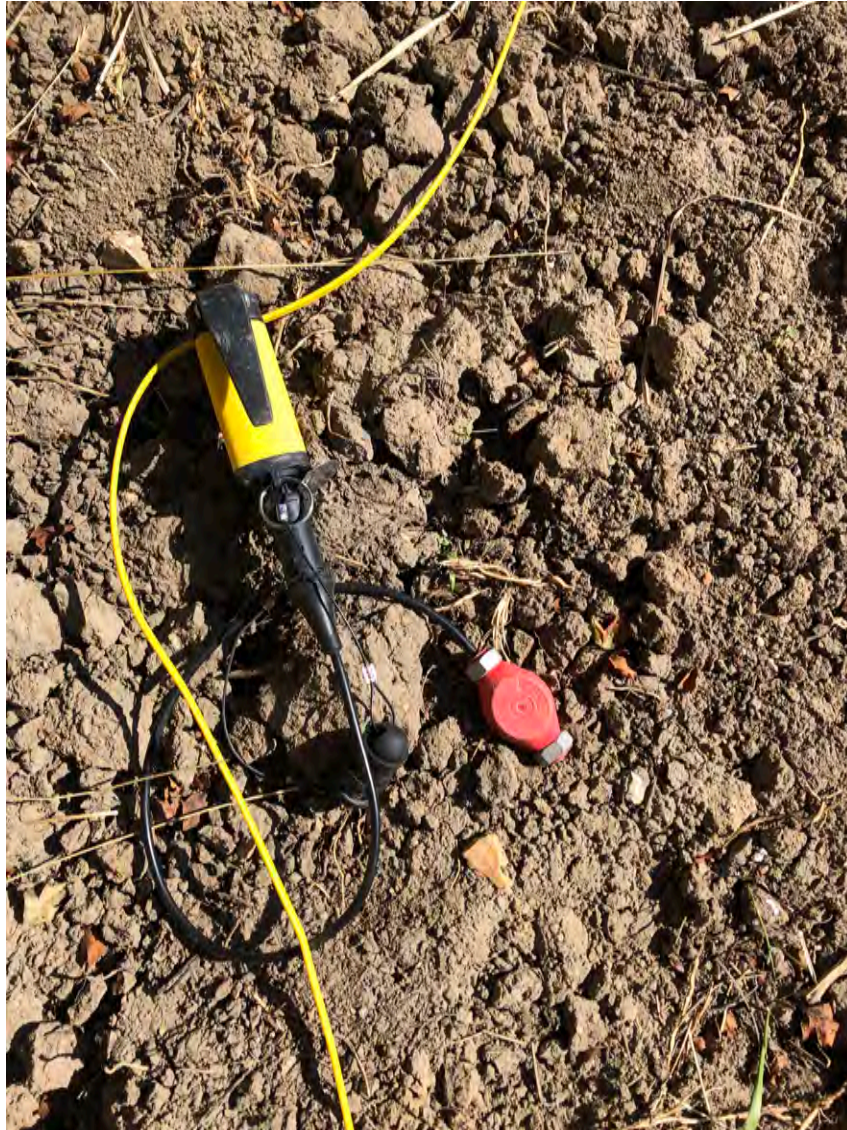
Figur 11 Exempel på geofon (här röd) och klämma (gul och svart), kopplad till kabel (gul). Från fältarbete i Tornhill.
