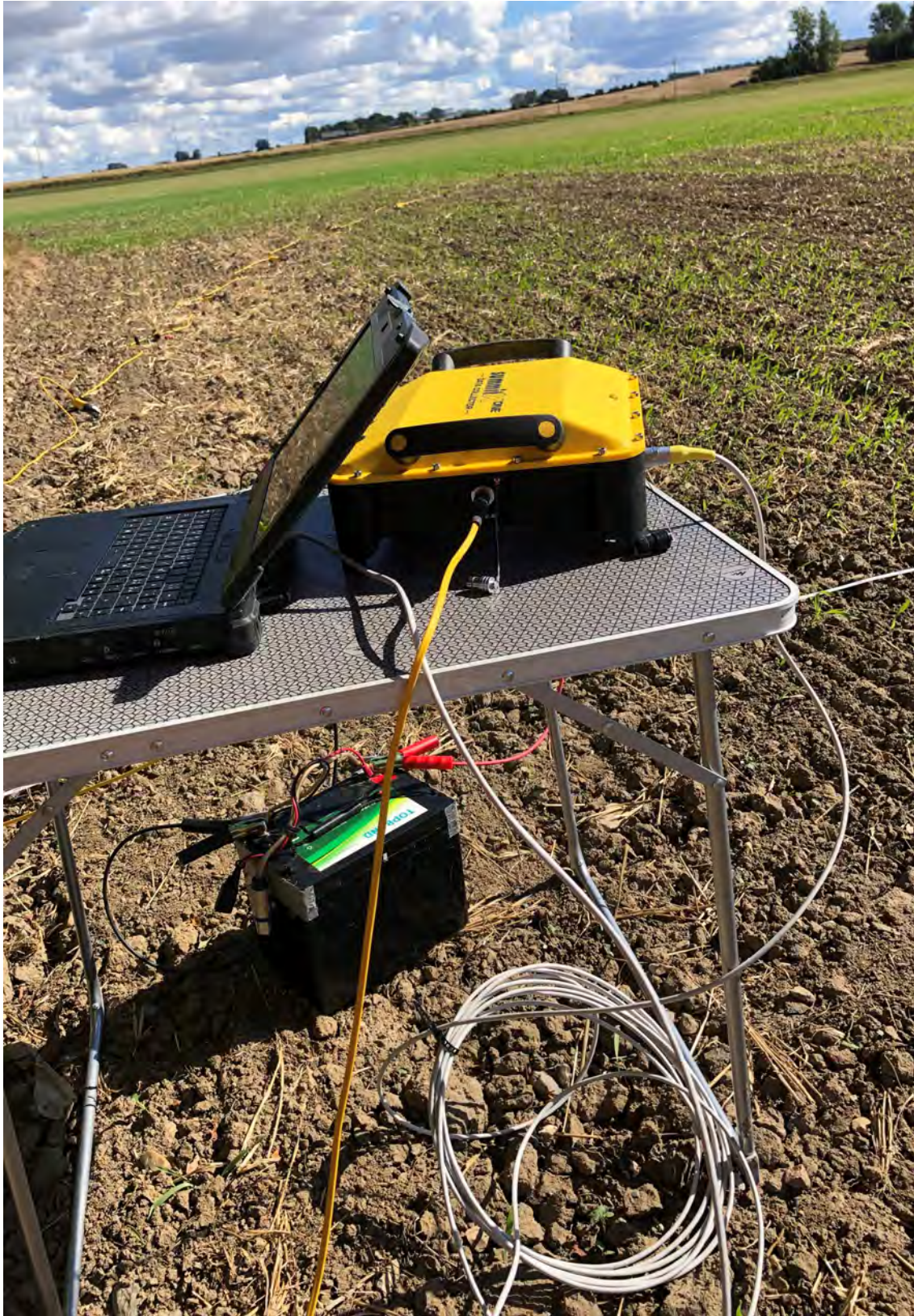
Figur 15 Centralenhet (gul) och fältdator (svart) på ett hopfällbart bord. Undertill ett batteri. Från mätning i Tornhill med stor cirkeluppställning.
