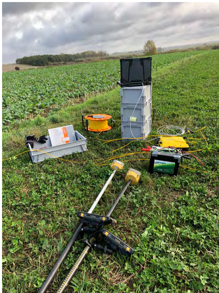
Figur 12 Delar av utrustningen som användes under fältarbetena, här från en mätning i Grevie. Bland annat kabel, GNSS-mottagare monterade på stänger med handdatorer, batteri, centralenhet samt fältdator placerad på upp- och nervända grå lådor, som geofoner och klämmor tidigare lastats i.
