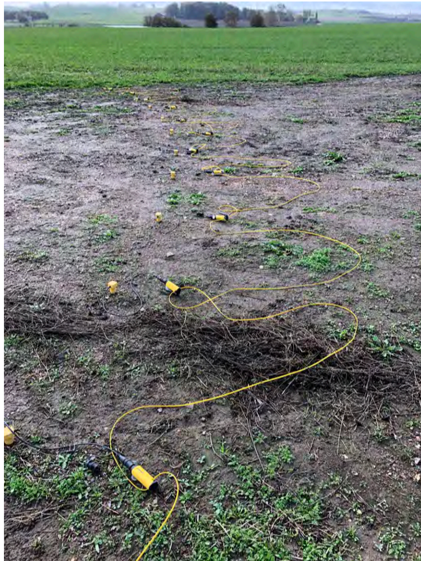
Figur 27 Cirkeluppställning i Grevie. Geofonerna är kopplade till kabeln med klämmor.
