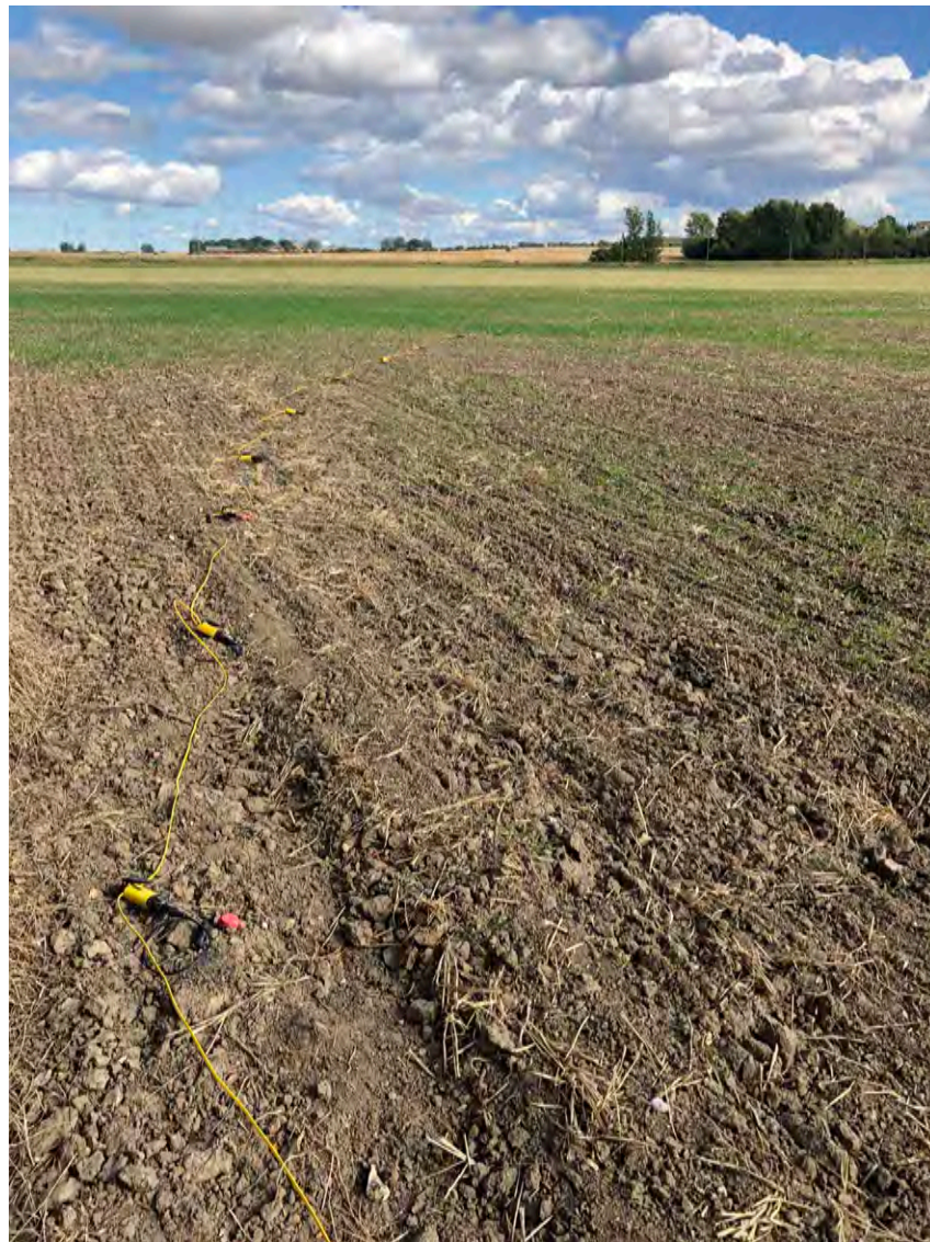
Figur 16 Geofoner utsatta i en cirkel med radie på 25 m i Tornhill. Totalt bestod cirkeln av 79 geofoner med knappt 2 meters mellanrum. Geofonerna (röda) kopplades till kabeln med hjälp av klämmor (gul-svarta).
