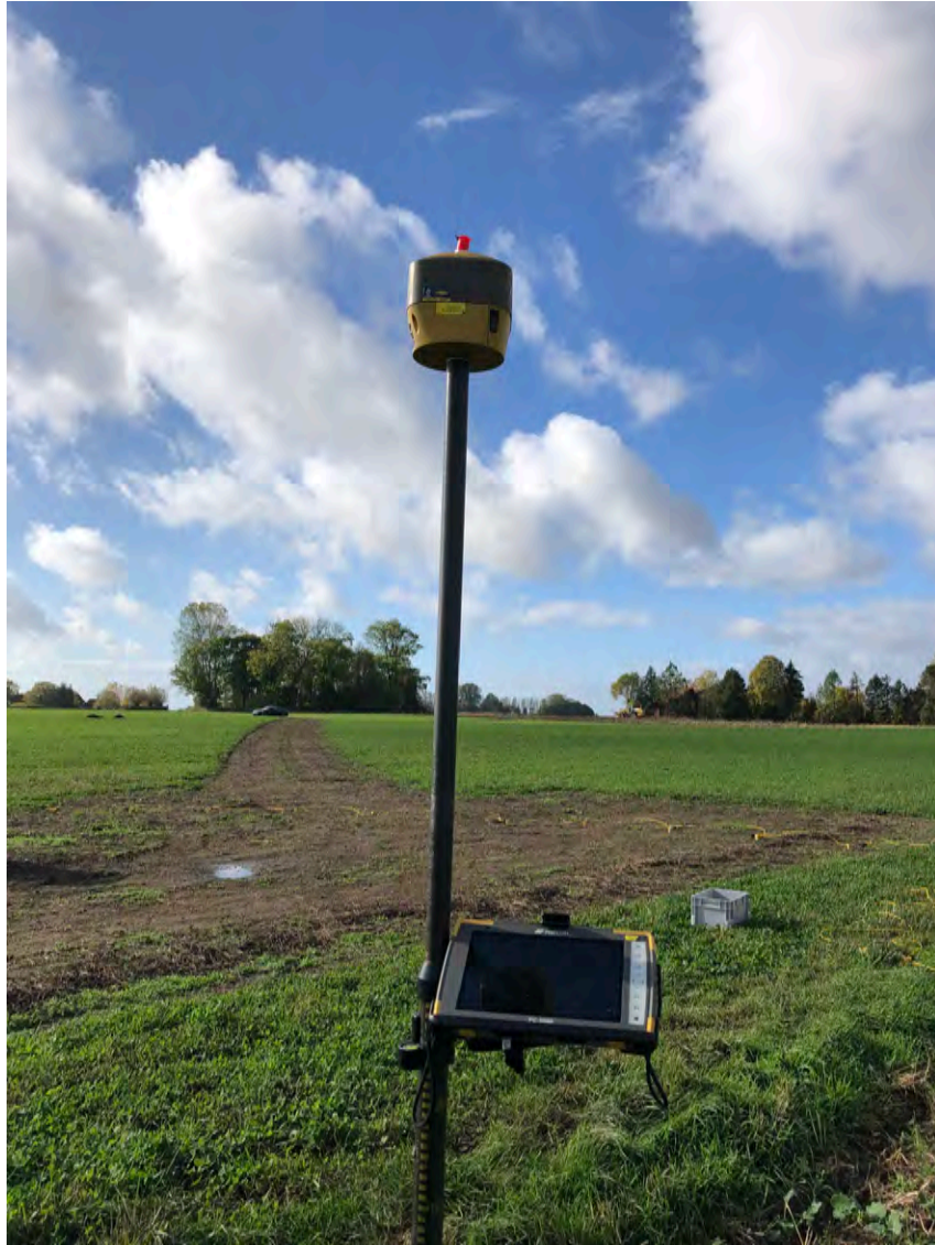
Figur 26 GNSS-mottagare i Grevie, monterad på stång med handdator.
