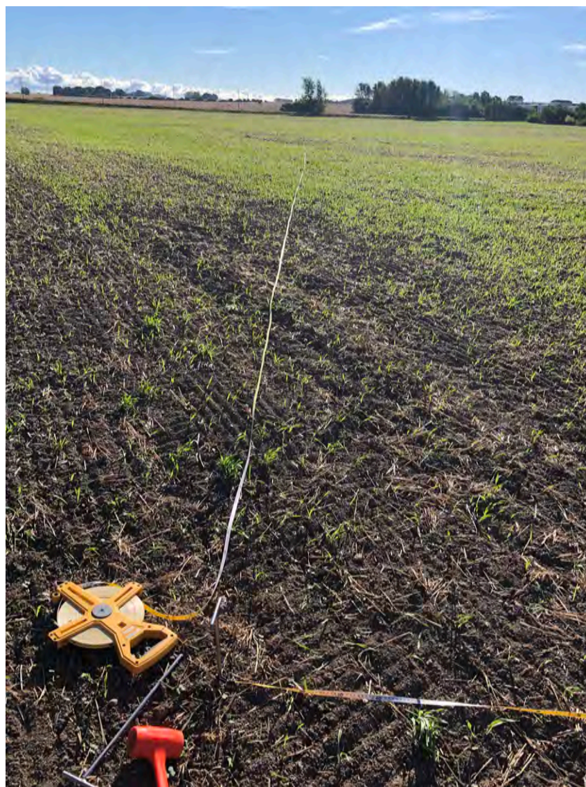
Figur 13 Mätband draget utifrån mittpunkten av cirkeln samt mätmarkörer, plasthammare och ytterligare ett mätband. Utrustningen användes för att sätta ut geofonerna på cirkelns ytterkant.
