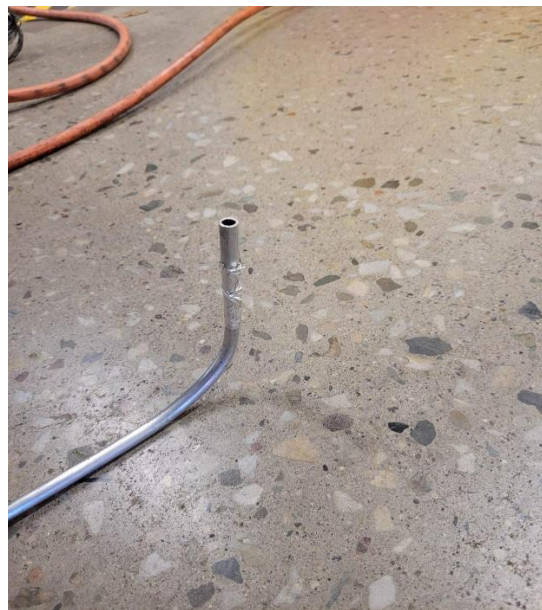
Figur 17. Visar munstycke om 5,5 mm.
