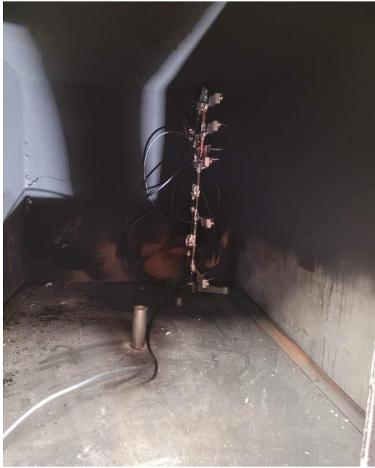
Figur 14. Visar placering av munstycket och stativ i Lådan.
