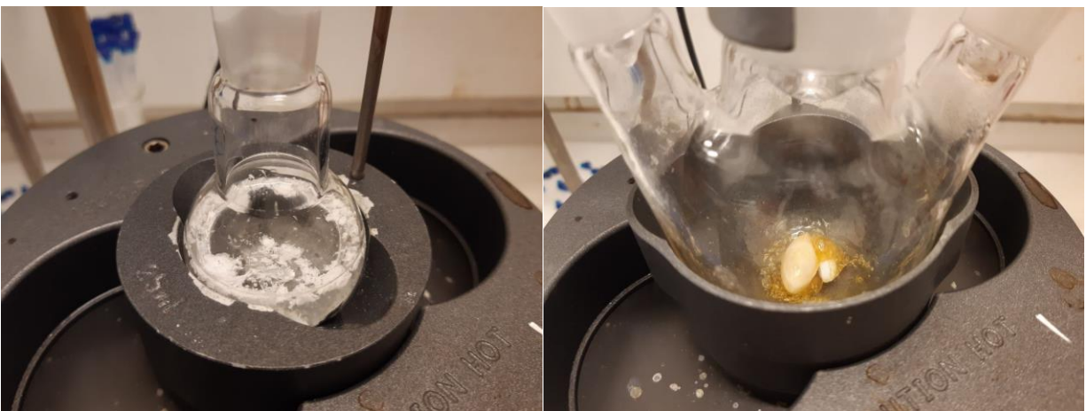
Till vänster bryts plasten när i stark syra och till höger reagerar de nedbrutna plastbeståndsdelarna med varandra för att bygga upp samma plast som bröts ned.
