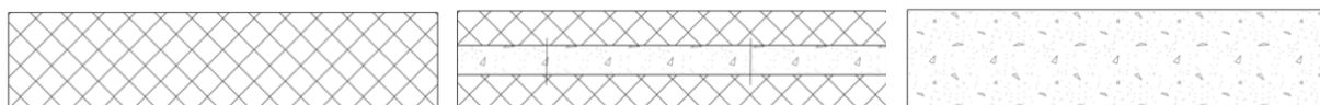
Figur 12: Figuren presenterar från vänster till höger; Horisontell sektion av en prefabricerad betongvägg, en vägg av prefabricerade ytterskivor av betong med fyllning av platsgjuten betong och en platsgjuten vägg av betong.
