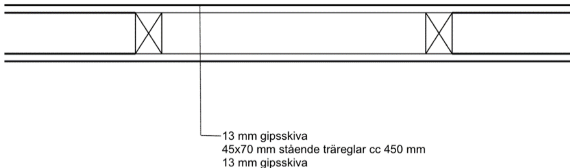
Figur 8: Ritning enkel gipsvägg med träreglar, horisontellt snitt.
