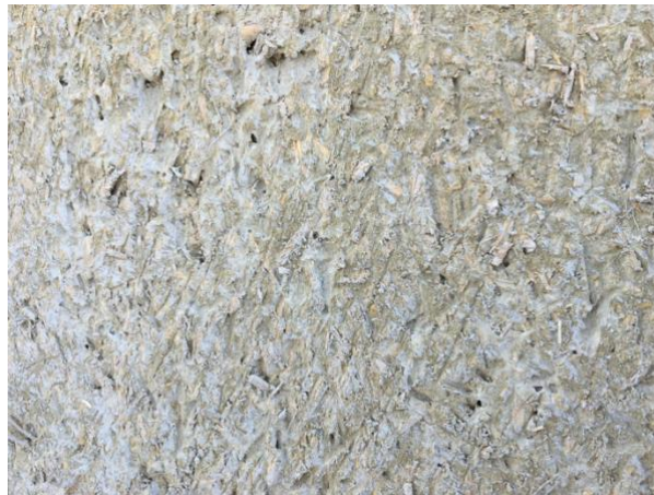
Figur 22: Hampakalk har en ljusbeige nyans där hampans vedämnen går att urskilja i form av skärvor i kalblandningen (Foto: Paulien Strandberg-de Bruijn 2023).
