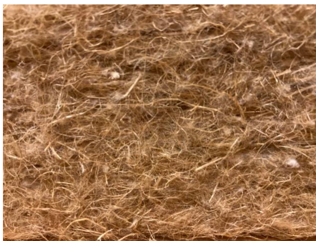
Figur 19: Hampafiberisolering har en ljusbrunaktig ton och en relativt grov fiberstruktur (Foto: Paulien Strandberg-de Bruijn 2023).
