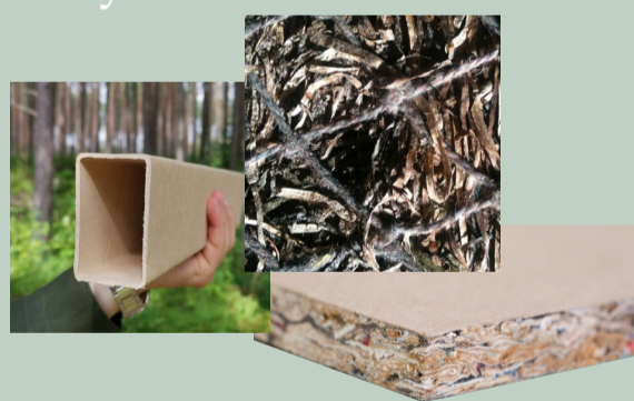
Figur 2: Illustrationen visar materialen/produkterna från vänster till höger: Pappregel, ålgräs, skiva av återvunna förpackningar, regel av spillmaterial från KL-träproduktion, hampafiberisolering, lerskiva, mycelium och återigen regel av spillmaterial från KL-träproduktion.
