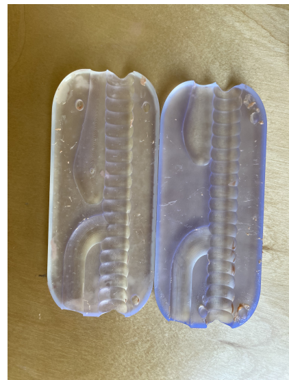
Figur 16. Färdig gjutform utskriven på SLA-skrivare i clear resin.
