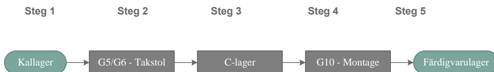
Figur 18 – Process för takstolstillverkning
