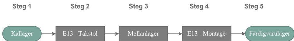
Figur 24 – Process för takstolstillverkning
