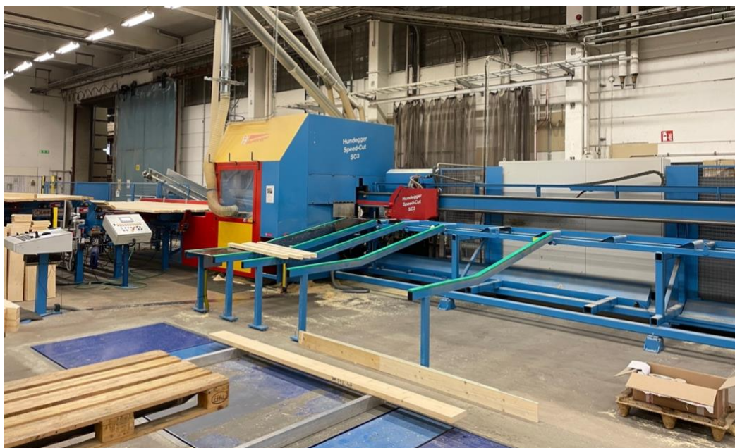
Figur 8 - Datorstyrd maskin (Götenehus) Maskinen kapar upp samtligt stomsvirke.
