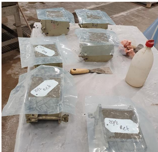
Figur 5.6: Gjutna kuber för tryckprovning.
