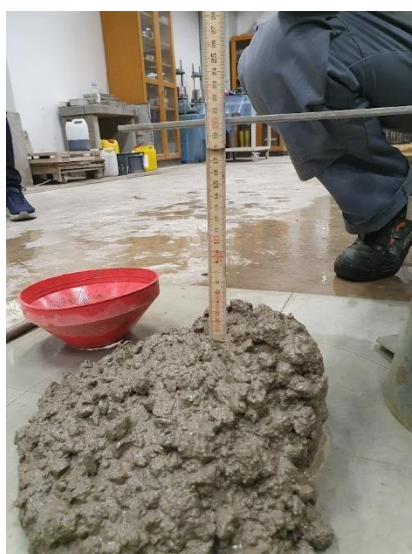
Figur 5.3: Sättnmätt av betong med ojämnt utflyt, ett medelvärde togs mellan övre och undre nivå.
