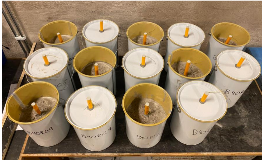
Figur 5.8: Hinkar med monterade fuktmätare.
