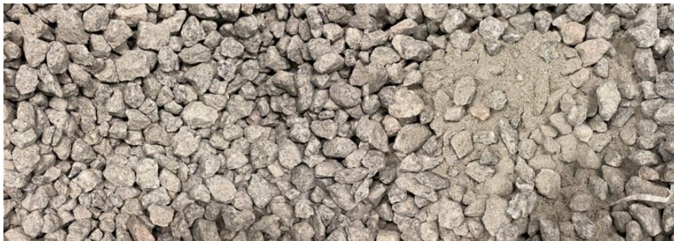
Figur 4.2: Glimmerrik bergkross fraktion 8/16 mm. Till höger i figuren syns en anrikning av finfraktion ovanpå den grova ballasten.
