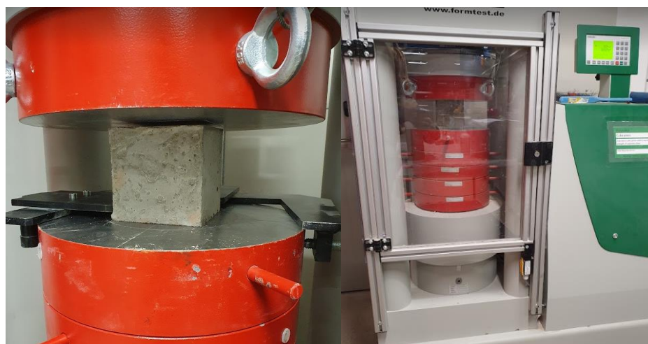
Figur 5.7: Tryckprovning med hydraulisk press.
