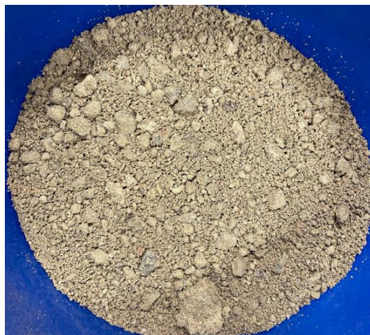
Figur 4.3: Återvunnen betong av fraktion 0/16 mm.
