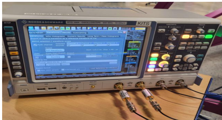
Figur 11. Lågpasfilter mellan källan och oscilloskopet.
