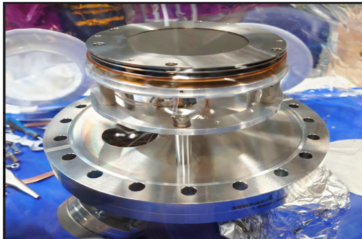
Figur 2. MCPn överst är en metalring mcp front. Nästa metallring under är mcp-back, och sedan en liten bit under så ligger delayline anoden.
