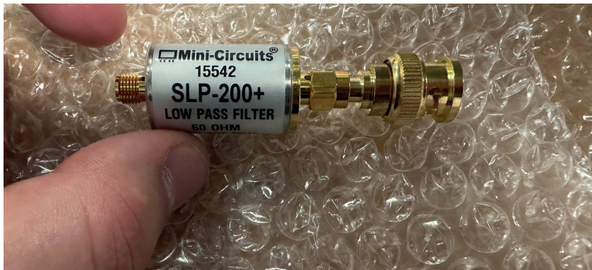
Figur 7. SLP-200+ lågpasfilter från Mini-Circuits som har en impedans på 50 ohm.
