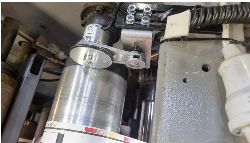
Figur 4.1.2.1. Bild på mät hjulet monterat på maskinen
