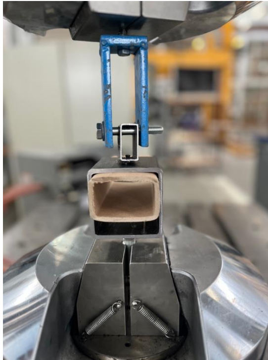
Figur 3:11 MTS provningsmaskin för utdragning av skruv.
