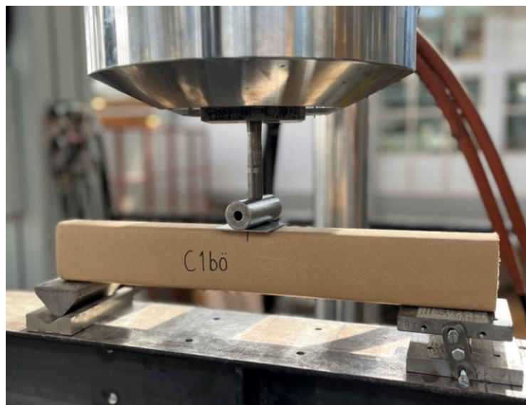
Figur 3:10 Fritt upplagd balk i MTS provningsmaskin. Balklängd 480 mm
