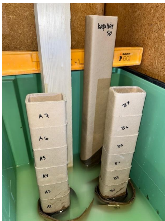
Figur 3:5 Bild efter 7 timmar i 45mm vattenbad
