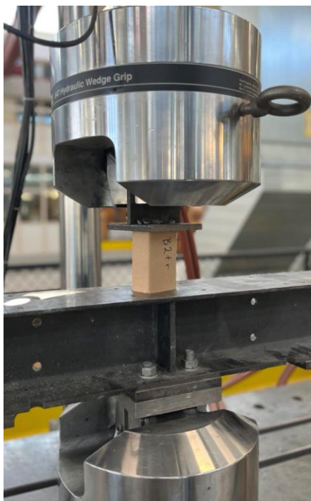
Figur 3:9 MTS provningsmaskin vid mätning av tryckhållfasthet och styvhet vid tryckbelastning.
