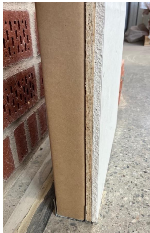
Figur 3:8 Väg med enkel gips och OSB.
