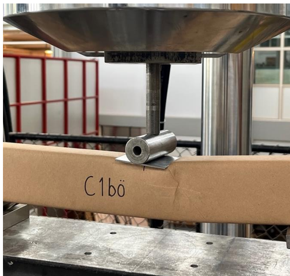
Figur 4:20 Deformation på 480mm balk vid RF 75%
