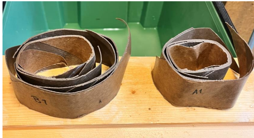
Figur 4:5 Nedersta provbitarna (0-50mm) efter 45 mm vattenbad i 24h.
