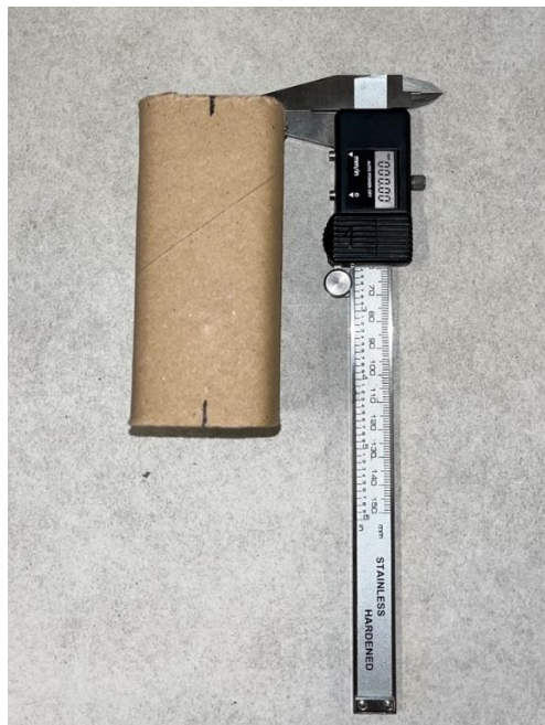
Figur 3:4 Digitalt skjutmått och provbit med markering.
