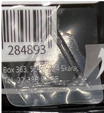
Figur 12: Produkten där den kännbara varningsmärknings utformad som en klisterlapp som satt löst på ena sidan.
