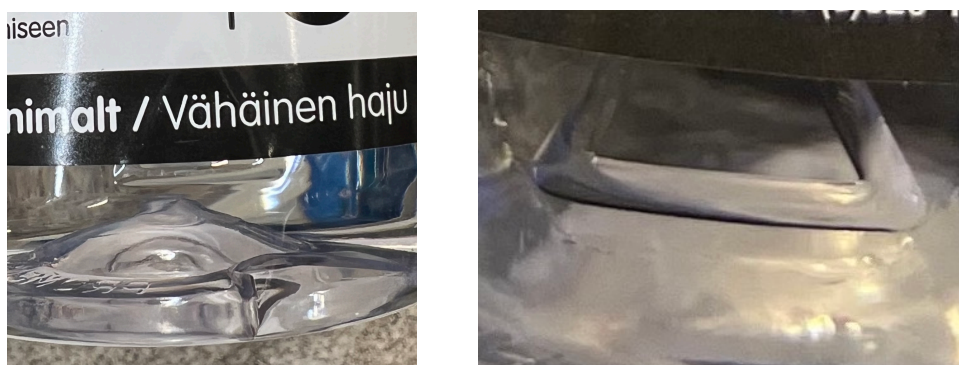
Figur 9: Två av produkterna där den känbara varningsmärkningsen var delvis övertäckt.
