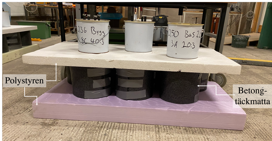
Figur 3.5: Värmeisolerade burkar. Burkarna placerade ovanpå är endast för att fungera som vikt och inte aktuella provkroppar i denna studie.
