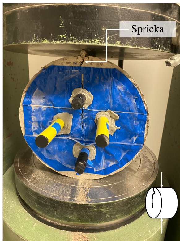
Figur 3.16: Spräckning av cylindrisk provkropp i kubpress. I fotot visas sprickan som delade provkroppen i två halvcylindrar.
