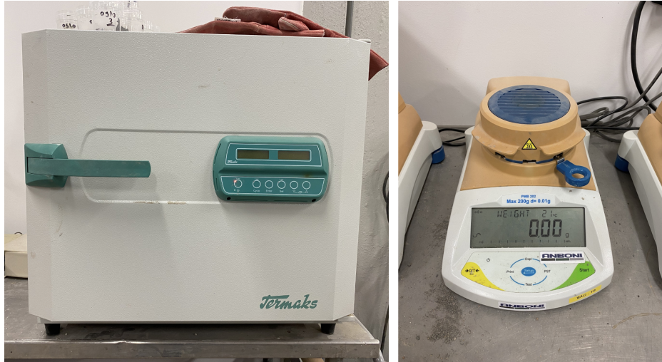
Figur 3.4: Värmeskåp från Termaks, modell B8054 (vänster) och fuktvåg från Anboni, modell PMB 202 (höger).
