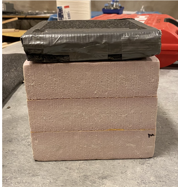
Figur 3.19: Isoleringsblock för transport av uttagna prov till fuktgeneratoren.
