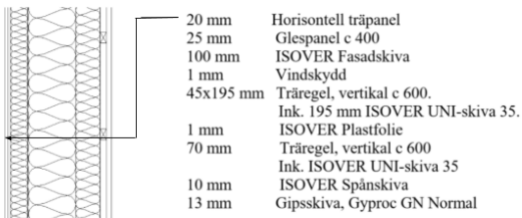
Figur 3: Träkonstruktionen av ytterväggar (Se bilaga 2).
