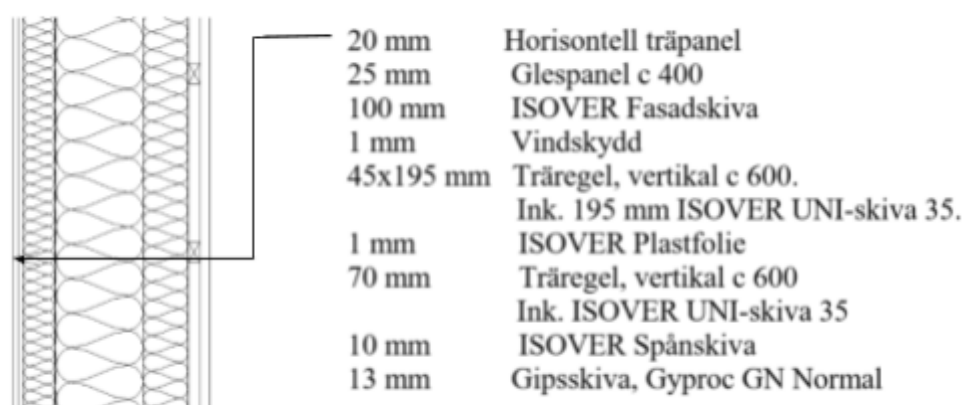
Figur 2: Träkonstruktionen av ytterväggar (Bilaga 2).
