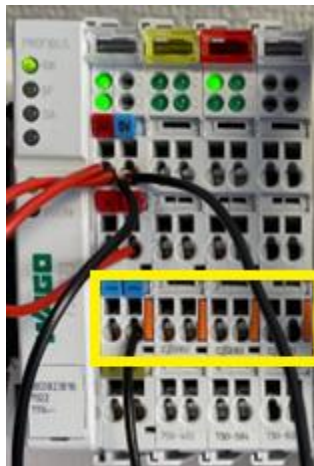
Figur 34. Orange-skena för utdragning av valfri I/O-modul
