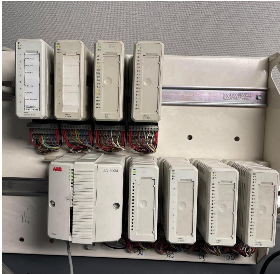
Figur 3. PM856 ihop med 2AI, 2AO, 2DI, 2DO med gränssnittet ModBus
