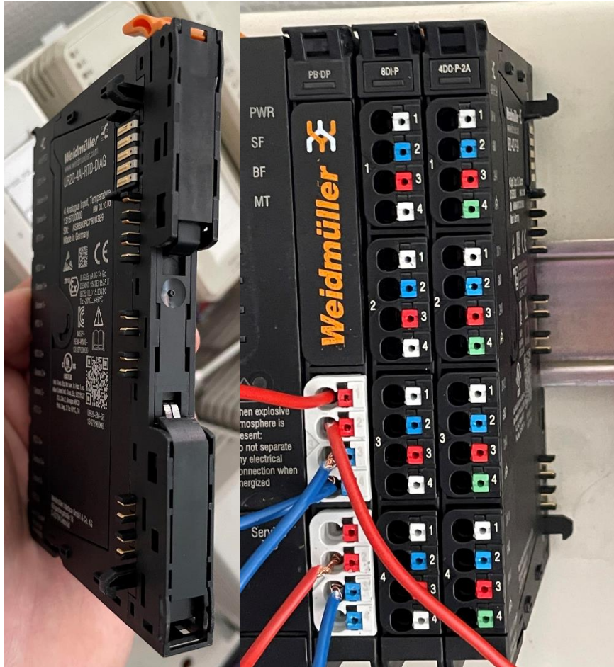
Figur 41. Kontakter som sticker ut förhindrar enkelt byte av modul
