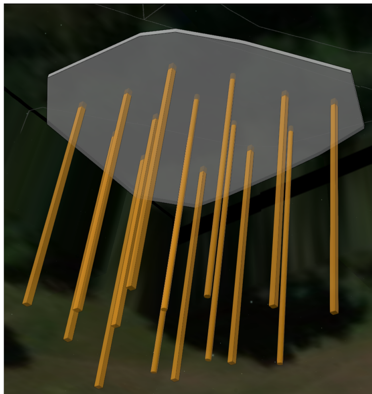
Figur 10.10: Delresultat på visualisering av pålar och påldäck underifrån i 3D. Både cirkulära och kvadratiska pålar visas i figuren.
