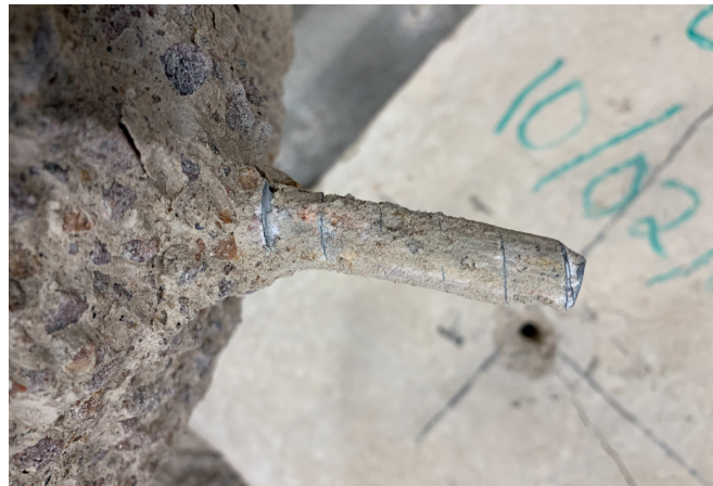
Figur 3.18: Utdragsbrott som uppkom vid dragprov.
