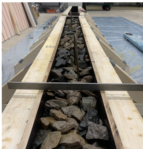
Figur 3.2: Placering av makadam i provbalkarna.
