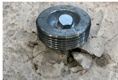
Figur 3.19: Utdragsbrott sett i plattan från dragprov.
