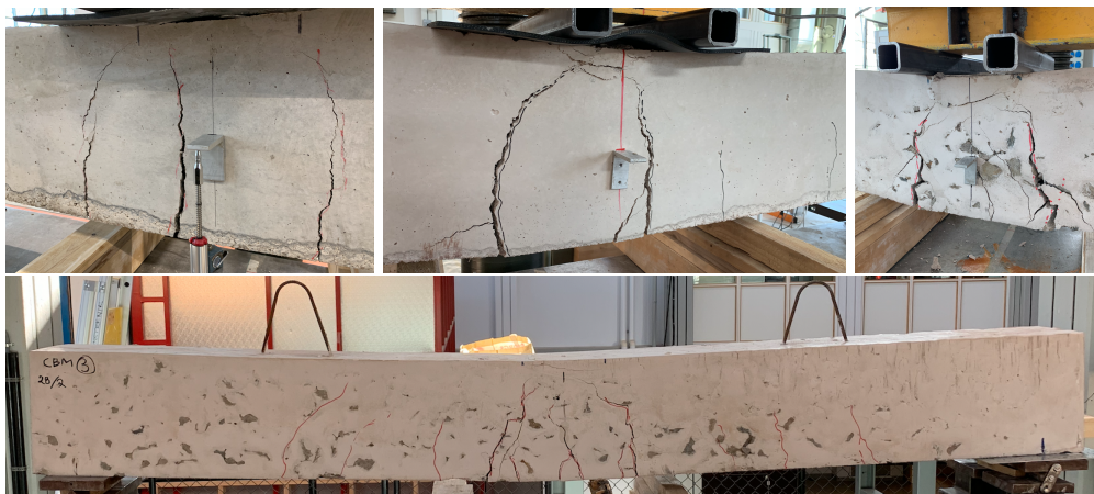
Figur 4.3: Sprickor i balkar: övre rad, från vänster till höger C25/30, LCB, CBM. Den undre visar en hel CBM-balk.
