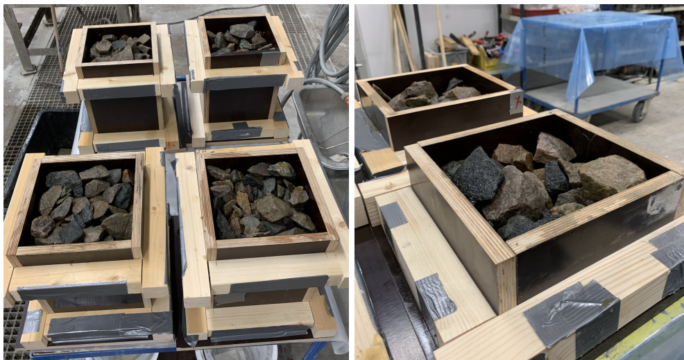
Figur 3.1: Formar fyllda med makadam.
