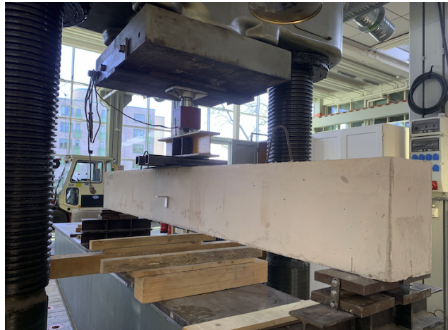
Figur 3.9: Balkuppställning innan provning.
