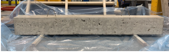
Figur 2: Färdig balk av cementbunden makadam
