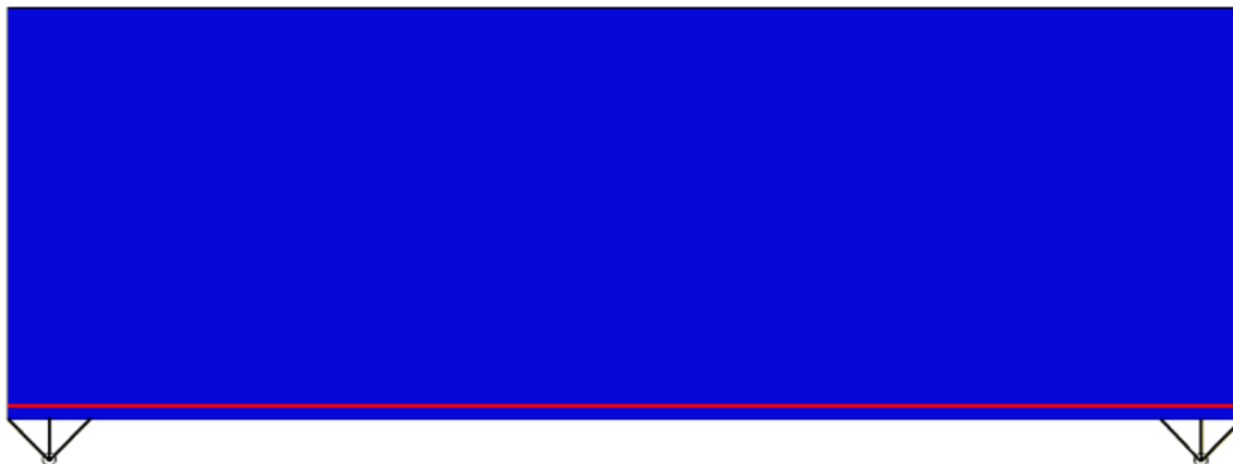
Figur 4.3: FE-modell. Blått är betong och rött är armering.
