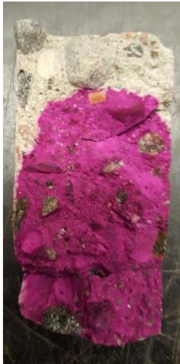
Figur 3: Betong som har utsatts med accelererad karbonatisering med en tydlig karbonatiseringsfront (L Andersson 2016)
