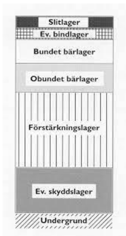
Figur 1 Principiell uppbyggnad av vägöverbyggnad (Asfaltboken 1999).
