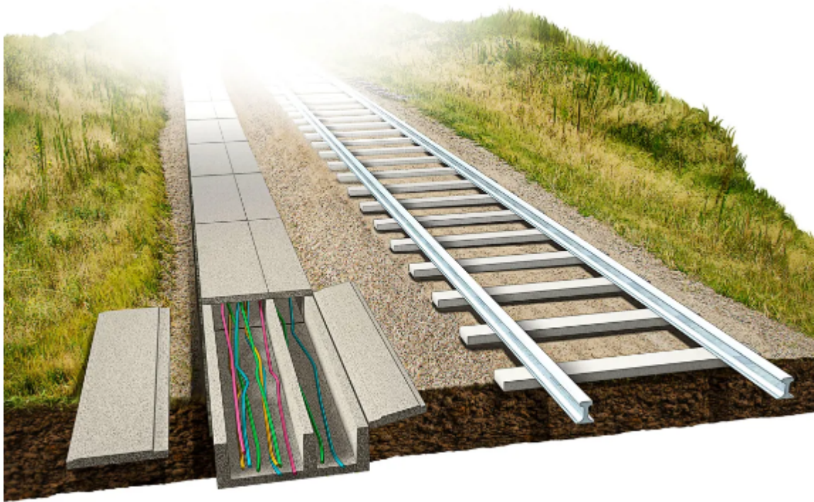
Figur 7. Bilden visar en kabelränna i anslutning till anlagt spår, denna typ av kabelränna kan nyttjas av både hög- och låg spänning och separeras i rännan (S:T Eriks. 2018).
