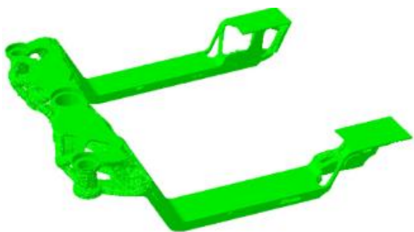
Bild: Design på mikromobilitet framtaget med hjälp av topologioptimering.
