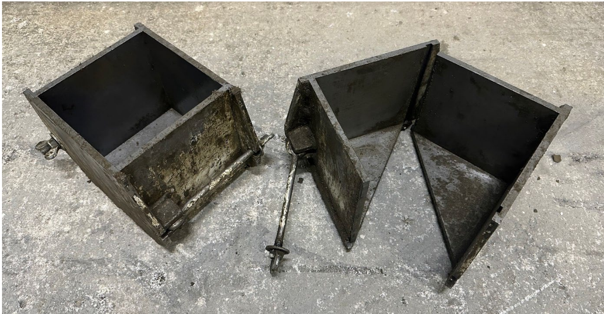
Figur 10. Standardiserade kubiska gjutformar avsedda för att bestämma tryckhållfasthet i betong.
