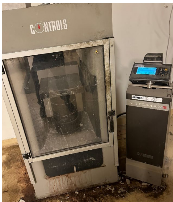
Figur 11. Utrustning för provning av kubers hållfasthet.
