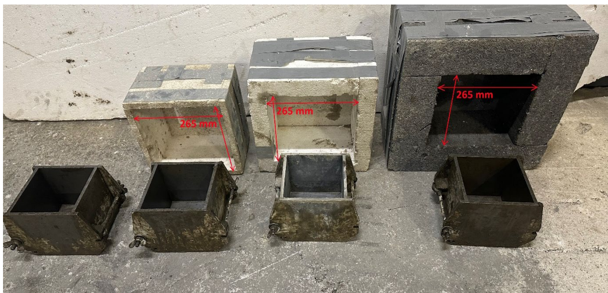
Figur 12. Kåpor som användes för att täcka gjutformarna.
