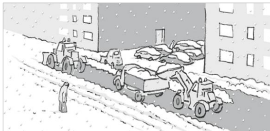
Figur 9. Snön plogas till vallar som körs bort (Trafikverket, 2022b).
