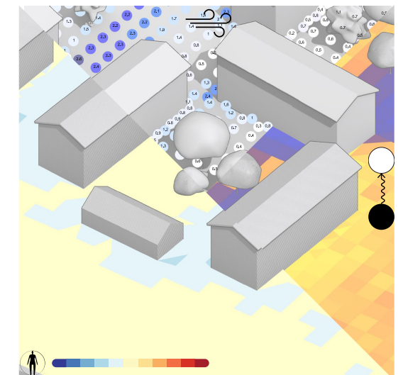
Fig. 75 En klimatkomfort-karta (vänster nedre) produceras genom sammanräknande av simulering av vind (överst), strålning (höger), samt ytterligare nödvändig klimatdata för den beräknade tidsperioden.
