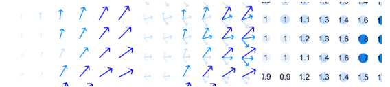
Fig. 74 Metod vindsimulering. Simuleringar av en vindriktning för sig (vänster) slås ihop (mitt) och ger ett medelvärde av vindstyrka för testpunkterna (höger). På så sätt kan en större tidsperiod av flera olika scenarion representeras i beräkningarna och ge en mer rättvis bild.
