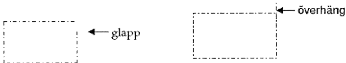
Figur 6.5. Bilden till vänster visar hur begränsningslinjerna inte sluter tätt och det har uppstått ett glapp. Bilden till höger visar hur en linje ligger utanför en yta och det har uppstått ett överhäng. [14]
