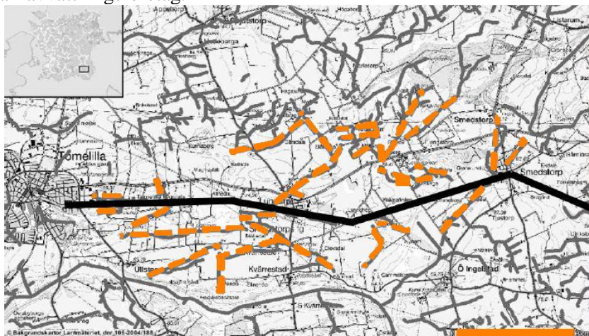
Figur 4. Figuren visar de olika markavvattningsföretag som berördes av att järnvägen, som är markerad med svart, stängde flertalet övergångar 313 .
