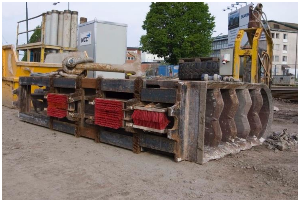
Figur 42 – Exempel på rengöringsaggregat för mekanisk rengöring av slitsens väggar (de längsgående borstarna) och slitsbotten (den taggformade botten). Aggregatet användes på E101 Malmö C nedre (Fotografi: Per Lindh 2006)
