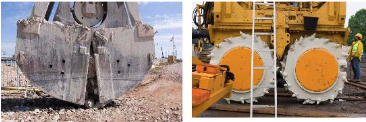
Figur 76 - T.v. Gripskopa för löst material. T.h. Fräs för hårt material (Möller & Blomqvist 2008, s. 31)
