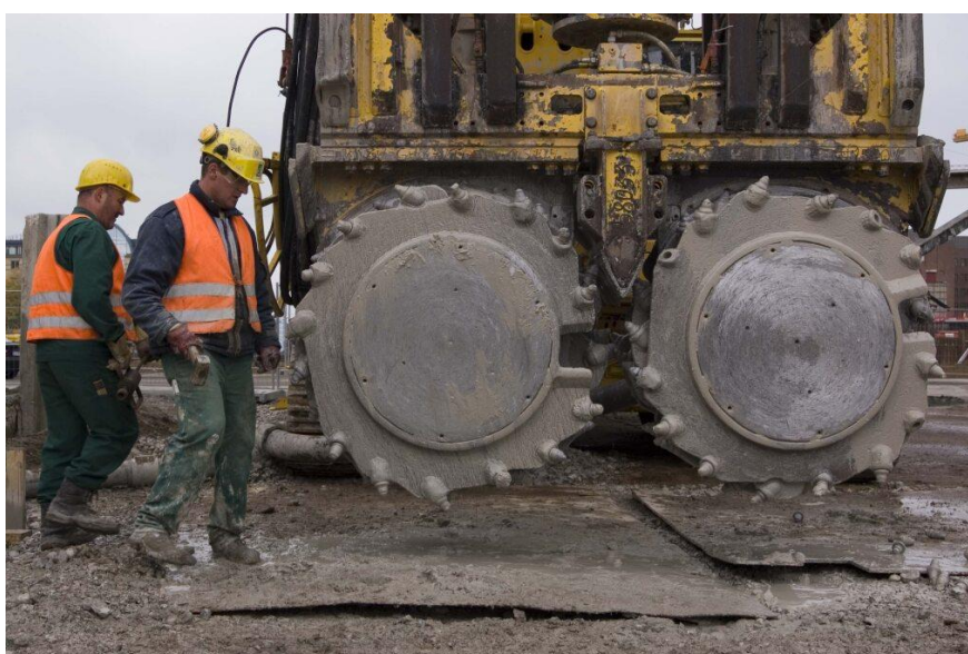
Figur 38 – Fräsaggregat används vid hårdare geologiskt material. Notera fräshjulens storlek (Fotografi: Per Lindh 2006)
