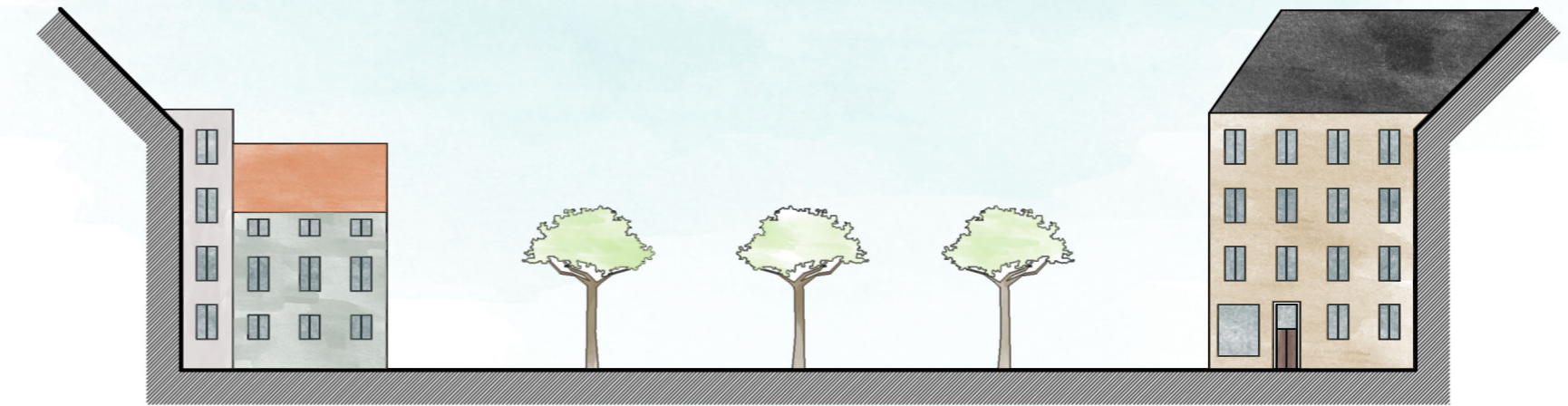
Sektion C-C - 72 m brett och 39 m djupt är torget som korsas av den 15 m breda spårvagnsgatan som går från Kista till Helenelund. Träden är i vy och står ej på torget.
