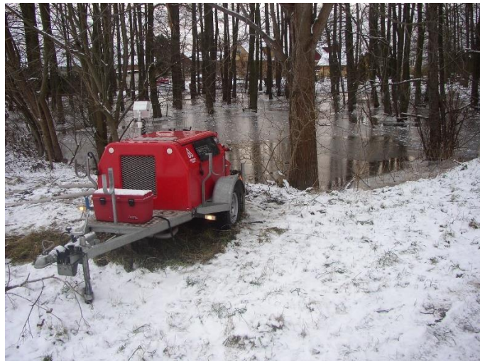
Figur 7: Bild från Kristianstad där en motorspruta används som pump för att hantera en översvämning. Bilden är tagen av Kristianstads räddningstjänst och används här med deras medgivande.
