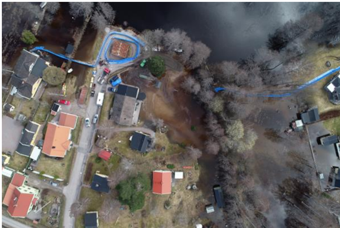
Figur 3: Bild från Gästriket där barriärer sätts upp som en skyddslinje för att skydda ett bostadsområde. Bilden är tagen av Gästrikets räddningstjänst och används här med deras medgivande.
